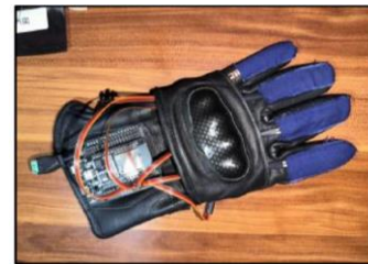
Gambar 7. Implementasi Pocket Sewing dan Integrasi Komponen Sumber : Hasil Olah Data
