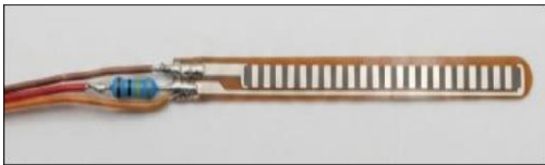
Gambar 8. Implementasi Rangkaian Pembagi Tegangan pada Sensor Sumber : Hasil Olah Data
